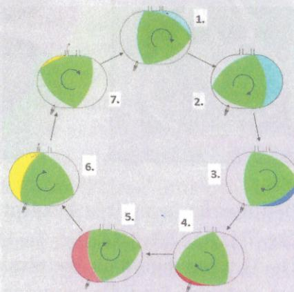
*Vsesavanje (1 in 2)* – Eden od rotorjevih vogalov med drsenjem po ohišju odpre sesalni kanal. V komoro priteka zmes bencina in zraka. Njena prostornina se med vrtenjem rotorja povečuje.
